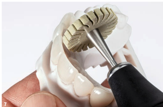
Abb. 5 Das Panther-Polymer-Konzept bündelt Instrumente für die Reduktion ausgeprägter Fertigungsspuren, die Homogenisierung der Oberfläche, die Bearbeitung filigraner Bereiche und die abschließende Politur. Abb. 6 und 7 Nach dem Verschleifen der Haltestege werden ausgeprägte Fertigungsspuren mit Panther Groove PS210 reduziert. Ziel ist eine gleichmäßigere Ausgangsoberfläche bei erhaltener anatomischer Grundform.
