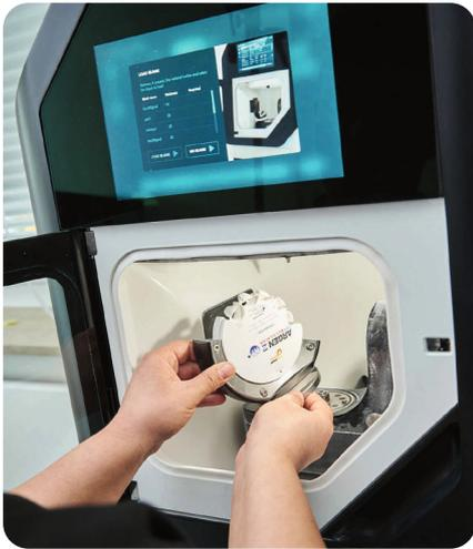
**05** Der C-Halter ist integraler Bestandteil der 5-Achs-Kinematik in der DS1 Plus. Besonders bemerkenswert ist, dass er sich um die Z-Achse vollständig drehen kann. Diese Drehung ermöglicht es, selbst schwierigste Geometrien wie Unterschnitte und komplexe Freiformflächen in einem Arbeitsgang zu fräsen – ohne das Werkstück umspannen zu müssen.
